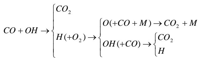
Из приведенной схемы следует, что скорость горения CO прямо пропорциональна концентрации CO и H<sub>2</sub>O. Очевидным является то, что цепной механизм процесса горения CO в струях кислорода, подаваемых над зоной продувки и навстречу потоку отходящих газов в конверторе, при температурах 1500–2500К и при стехиометрических соотношениях компонентов горения, не является лимитирующим.
