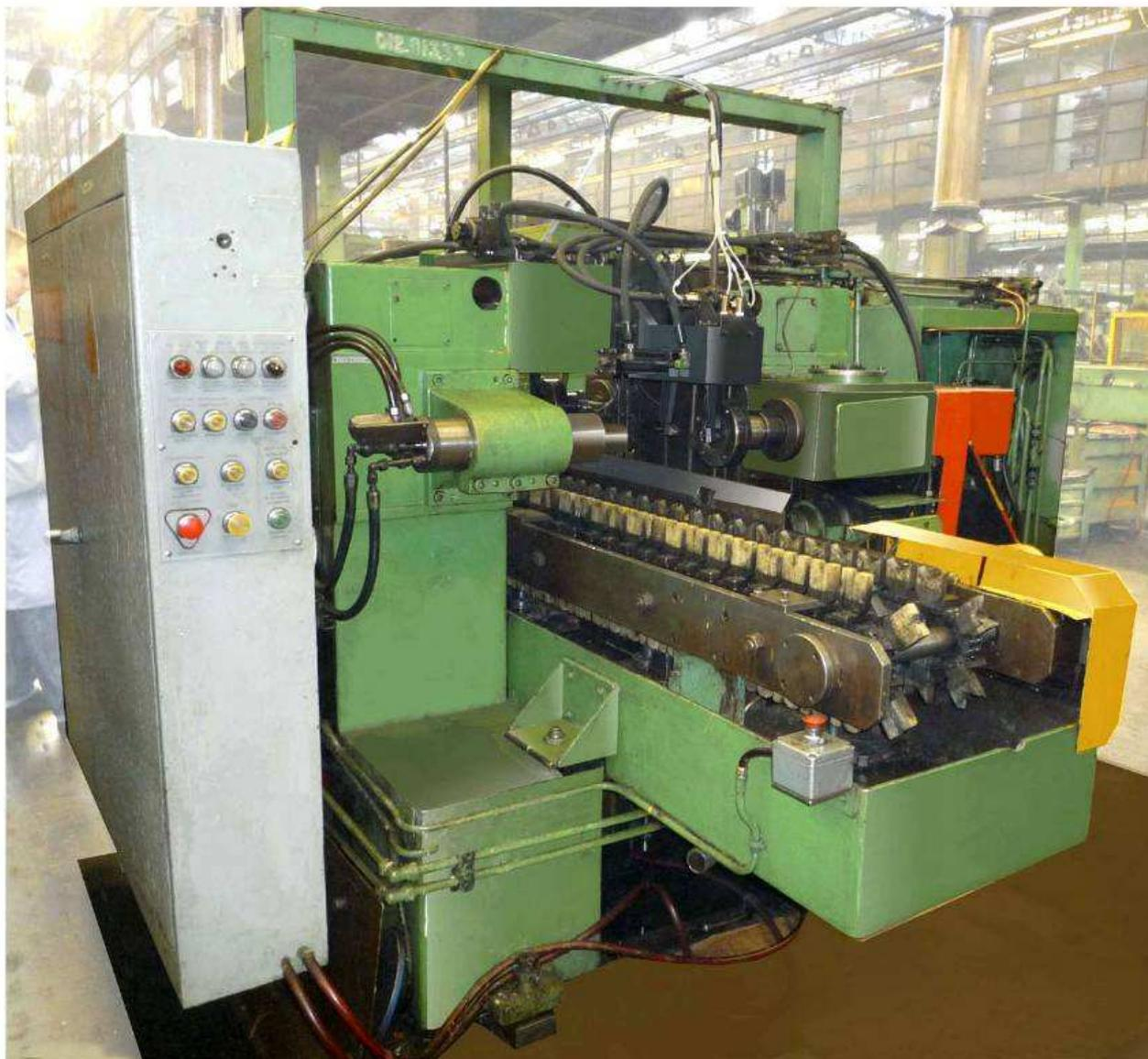
Рисунок 1. Рабочая зона станка для обработки вала первичной КПП автомобилей классической компоновки
