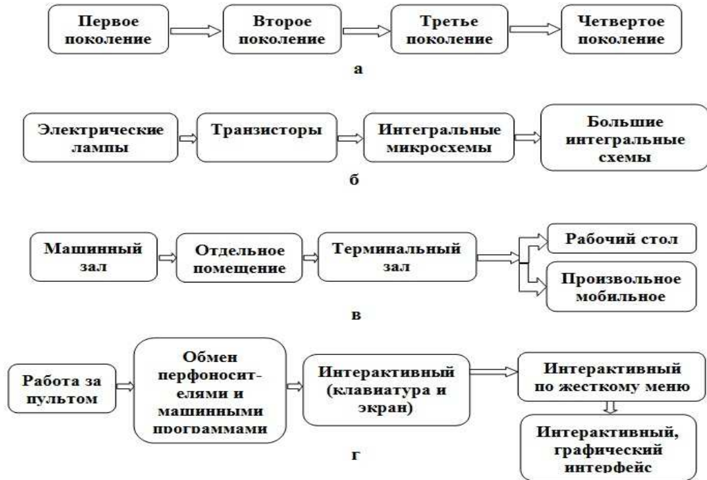
Рисунок 1: а) Этапы развития аппаратного обеспечения (ЭВМ), б) Развертывание – свертывание технической базы ЭВМ, в) Динамизация ЭВМ и г) Повышение управляемости ввод-вывода ЭВМ
