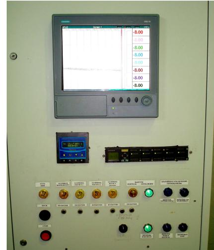
**Рис. 4. Фото термокамеры для полимеризации сотовых панелей**
