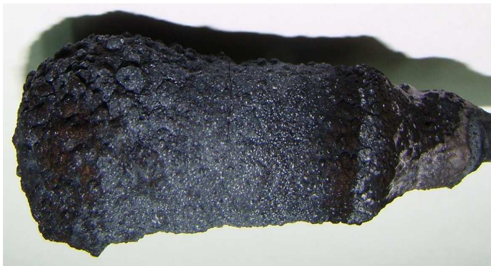
Рис. 4. Фотография катодного осадка, полученная при T = 630\text{ }^{\circ}\text{C} , I = 1\text{ A} .
