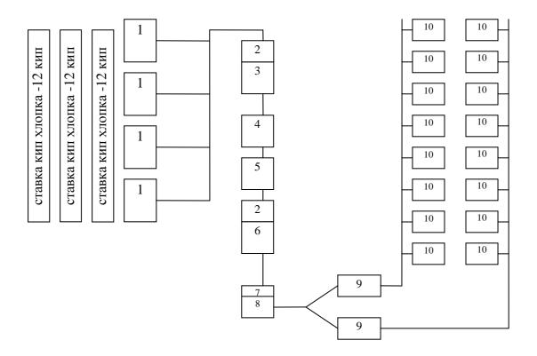
Рис 1. Технологическая схема выработки чесальной ленты на ОАО «Росконтракт-Камышин» до технического перевооружения
