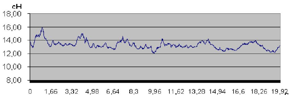
Рис. 2. Диаграмма изменения натяжения нитей основы линейной плотностью 29 текс на шлихтовальной машине ШБ-11/140-1
