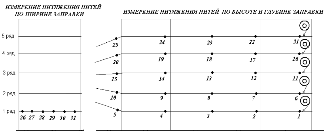
Рис. 1. Точки на рамке сновальной машины СП-140, в которых проводились измерения натяжения нитей основы линейной плотностью 29 текс
