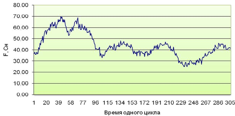
Рис. 3. Тензограмма натяжения нитей в первой точке эксперимента на ткацком станке СТБ-2-216
