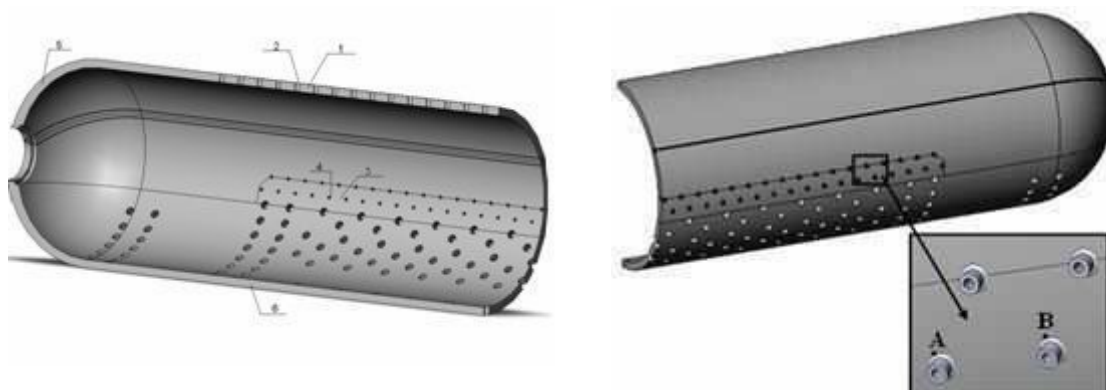
Рис. 1. Твердотельная модель барабана и схема расположения зон контроля температуры.
