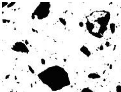
Рисунок 1. Микроструктура шлама (увел.200): 1-графит, 2-криолит
