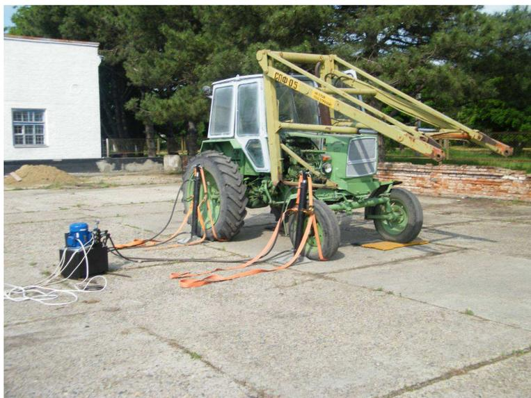
Рисунок 1. Мобильный стенд для определения угла поперечной статической устойчивости
