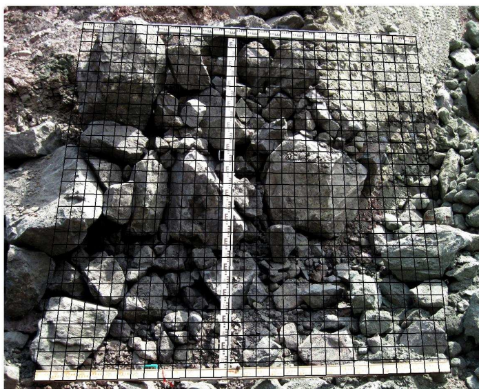
Рис. 3. Пример фотопланограммы забоя экскаватора ЭКГ-12,5.
