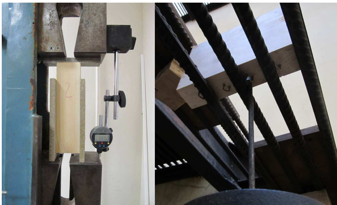
Рис. 1. Определение несущей способности соединения скобой; слева – на сдвиг, справа – на выдергивание
