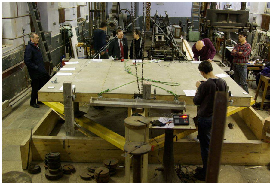
Рис. 2. Экспериментальные исследования полномасштабной модели стеновой панели.
