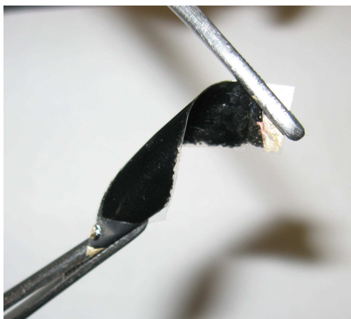
Рисунок 6. Вид гибкого ультратонкого суперконденсатора на основе композита ПАНИ/фМУНТ и гелевого электролита
