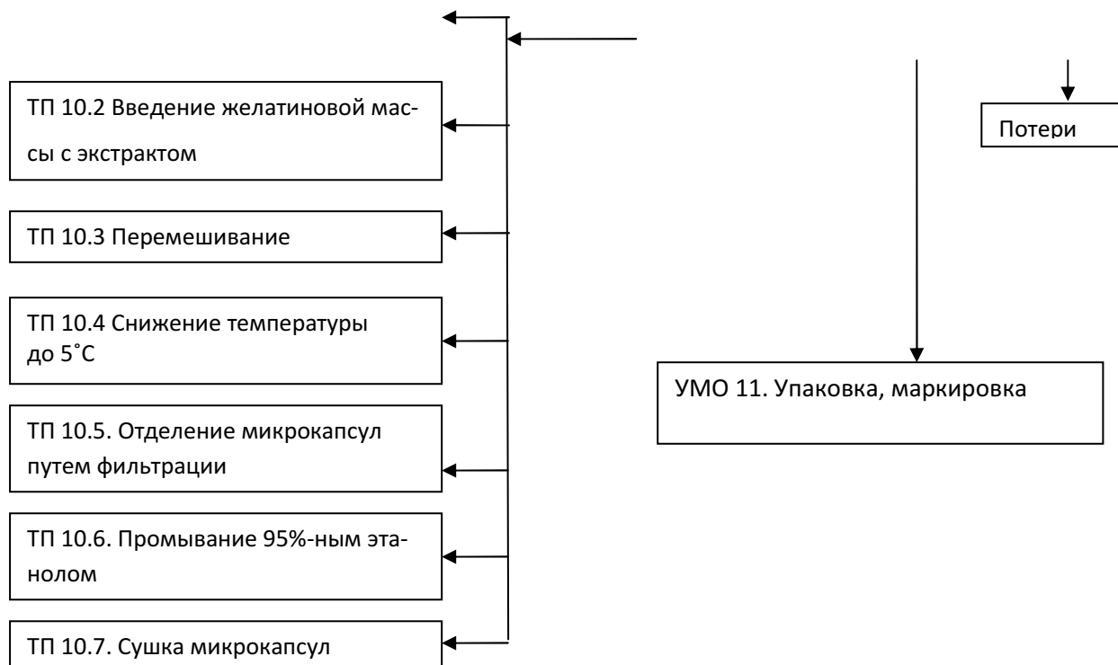
Рис. 2. Технологическая схема изготовления микрокапсул: ВР – вспомогательные работы, ТП – технологический процесс, УМО – упаковка, маркировка.
