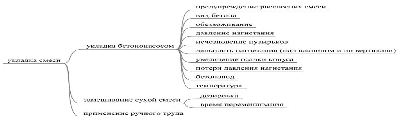
Рис. 1 Факторы (первичные и вторичные), влияющие на подвижность цементобетонной смеси (подгруппа «укладка смеси»)
