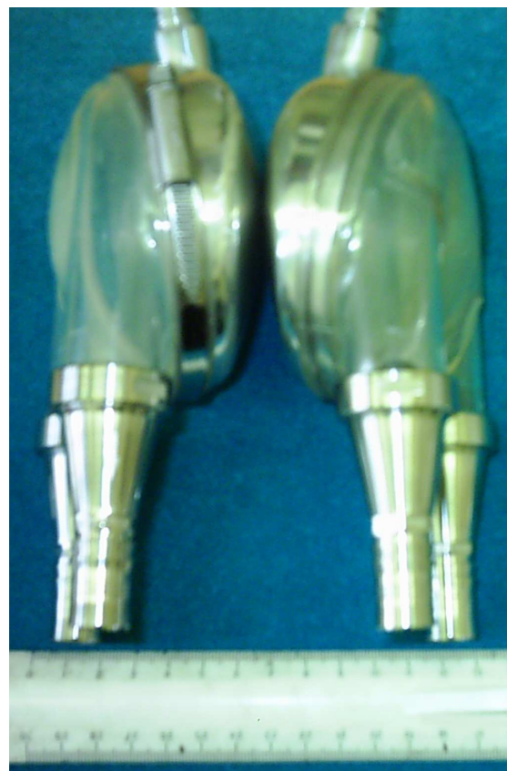
Рис. 5. а) – методика проектирования мембранного ИЖС, с заданными гемодинамическими показателями; б) – опытные образцы системы ВК на базе ИЖС, спроектированного с применением описанной методики с пневмоприводом
