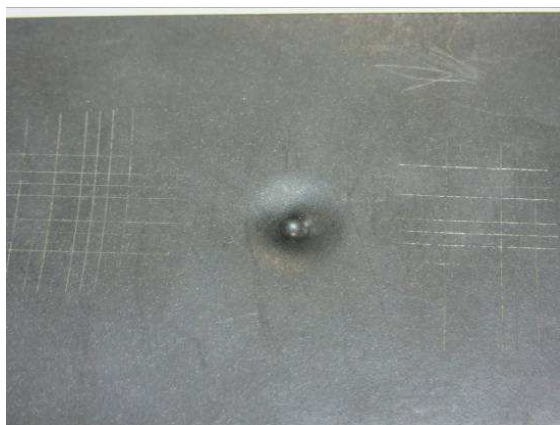
Рисунок 2. Вид места приложения прямого удара покрытия на базе ПС, произведенного на установке Константа У-2М
