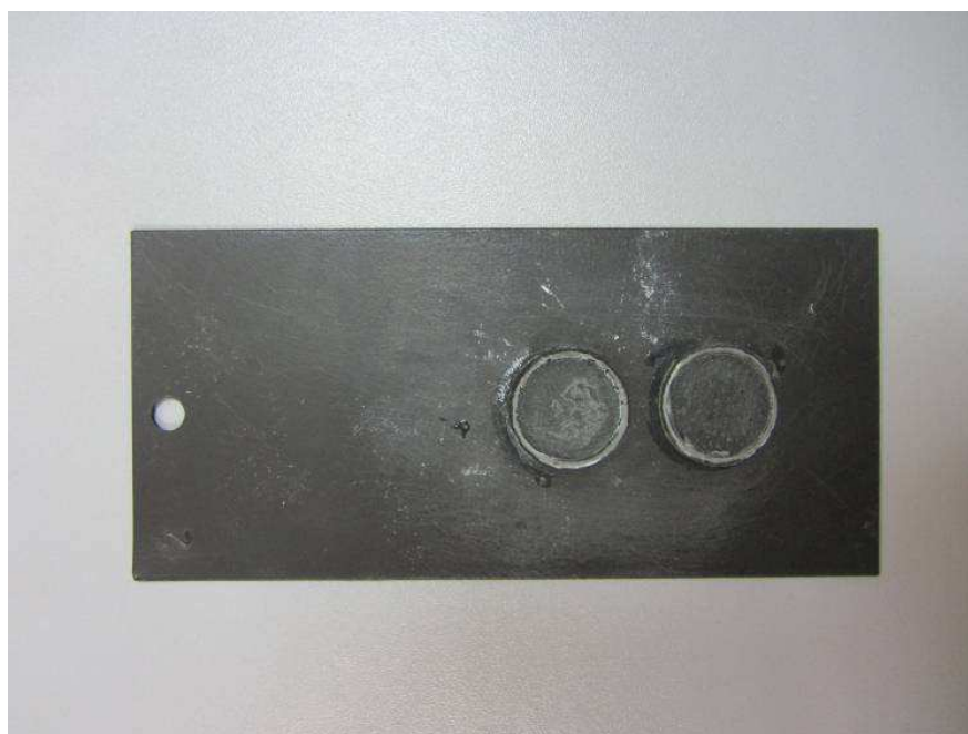
Рисунок 2. Испытания адгезии на отрыв покрытия системы полисульфон/ПТФЭ 4-МБ/TiC (85/10/5 % масс.)
