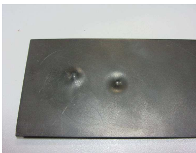
Рисунок 1. Поверхность покрытия системы ПФС/ПТФЭ 4-МБ/TiC (75/20/5 масс. %) после прямого и обратного удара, произведенный на установке Константа У-2М с высоты 100 см
