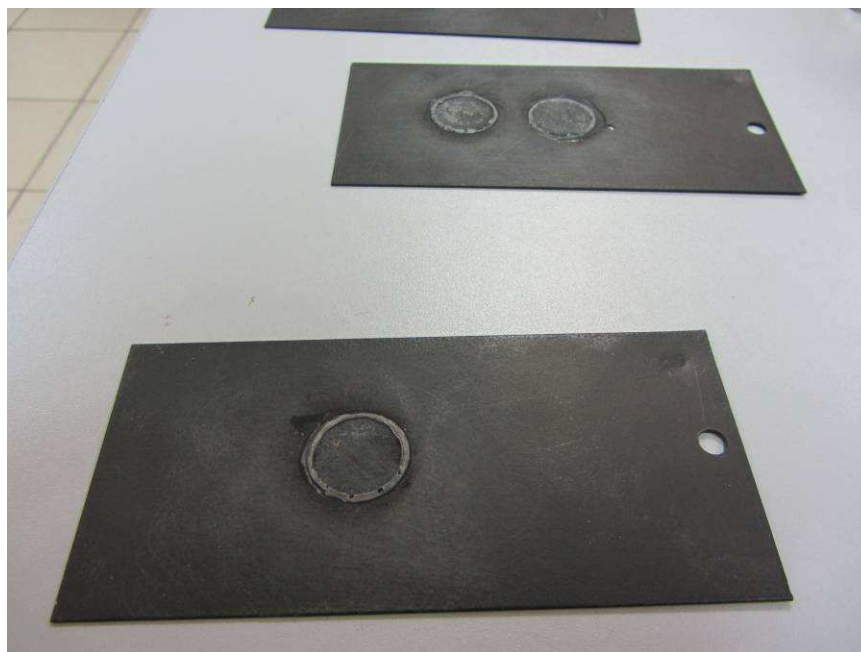
Рисунок 4. Испытания адгезии на отрыв покрытия системы полифениленсульфид/ПТФЭ 4-МБ/ТiС (85/10/5 % масс.)
