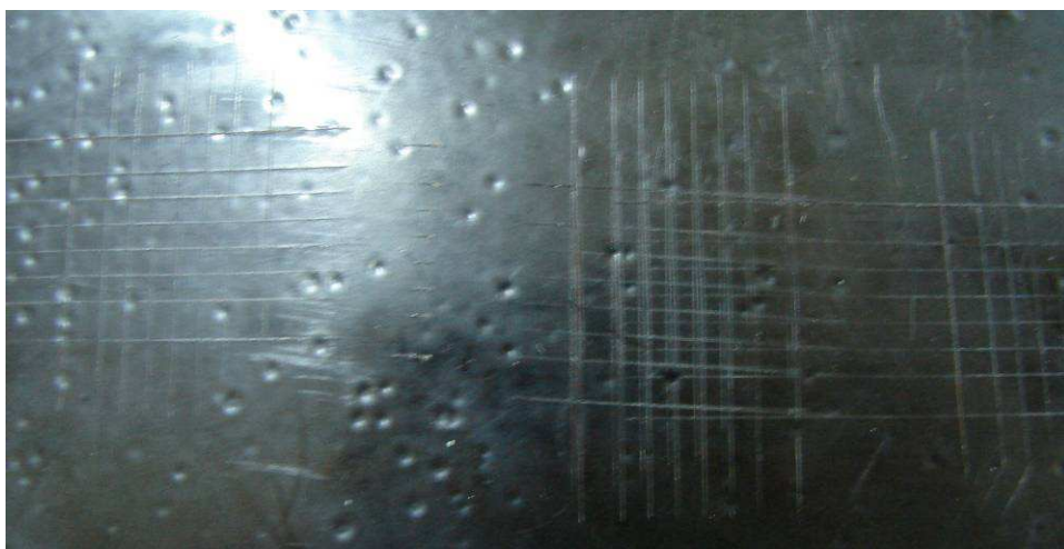
Рисунок 2. Решетчатый надрез покрытия системы ПФС/ПТФЭ 4-МБ (5 масс. %)
