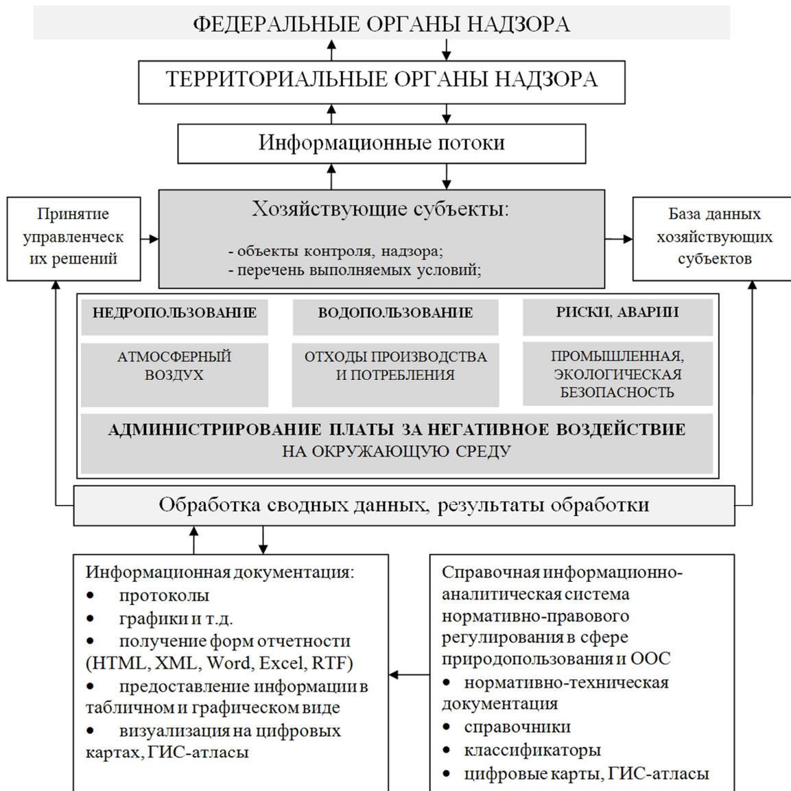
Рисунок 1. Блок-схема основных функциональных возможностей ПК ГИАС «Экобезопасность»
