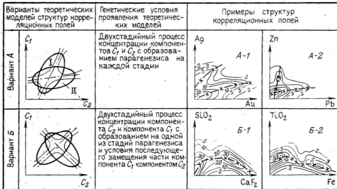
Рис.1. Варианты структур корреляционных полей полигенерационных руд (по В. Ф.Мягкову [3]). Справа приведены примеры структур по месторождениям: золоторудного (А-1), Азатекского полиметаллического (А-2), Амдерминского флюоритового (Б-1), Баронского титаномagnetитового (Б-2)
