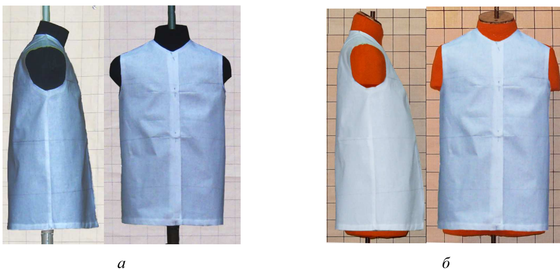
Рис. 1. Оценка посадки стана плечевой одежды на существующем (а) и разработанном (б) материальных манекенах девочки младшего школьного возраста
