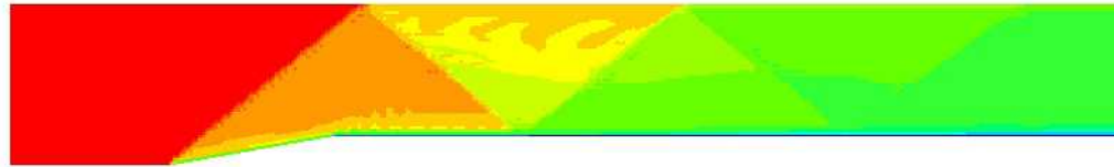
Рис. 3. – Задача о сверхзвуковом обтекании клина: распределение полного давления ( явная схема, WENO3 без ограничителей).
