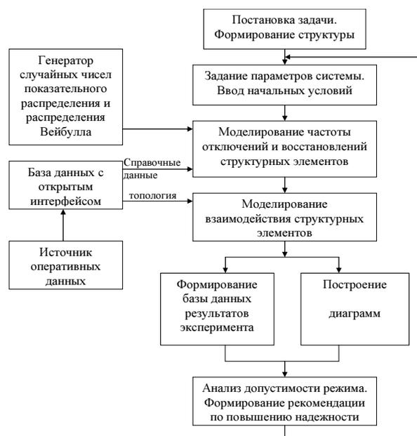
**Рис. 1. Алгоритм функционирования активно-адаптивной модели.**
