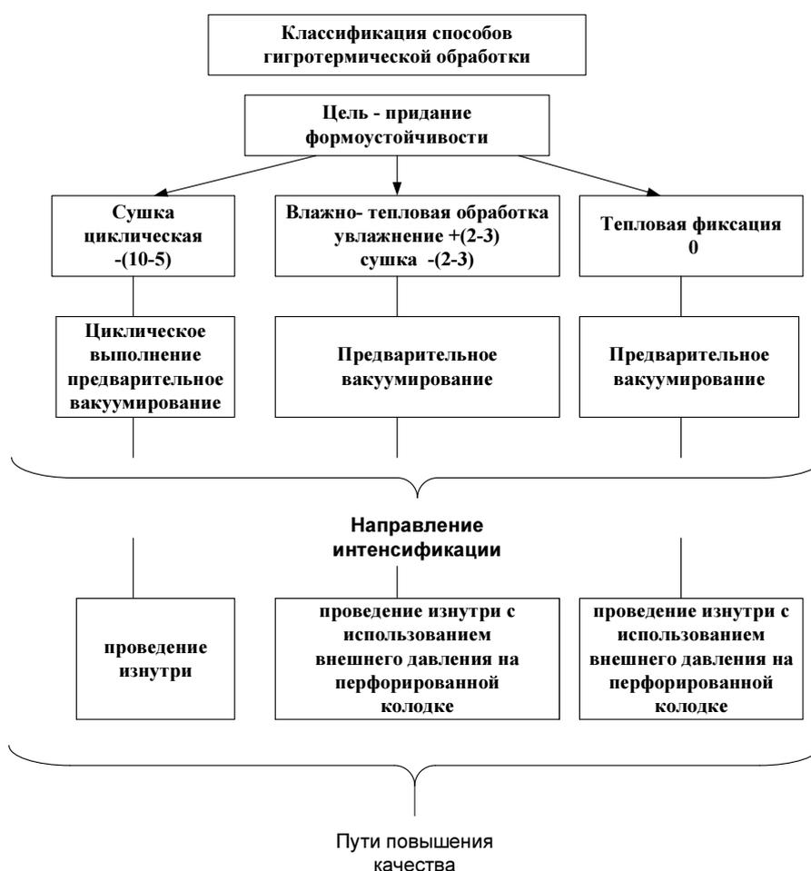
Рисунок 2 – Классификация способов гигротермической обработки для придания материалам легкой промышленности свойств (заготовок верха обуви) формоустойчивости и направления их интенсификации
