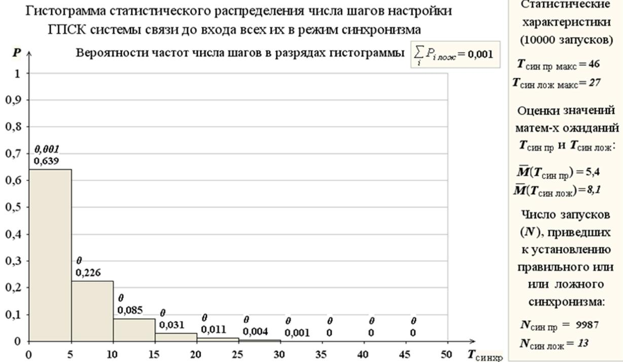
Рис. 1 и рис. 2. Вид панелей модели и результаты моделирования процесса установления синхронизма двух ГПСК при значительной вероятности  $q$  ошибки в приёме бита кода
