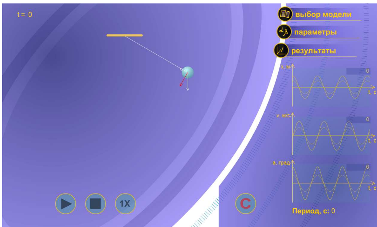
Рис.1. Иллюстрация к задаче о математическом маятнике. Векторами показаны силы, действующие в данный момент времени на шар. На графиках отображены зависимости координаты, скорости и угла от времени
