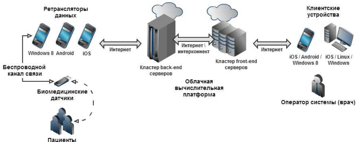
Рис. 1. Проектируемая архитектура распределенной системы ретрансляции данных с клиентскими мобильными приложениями.
