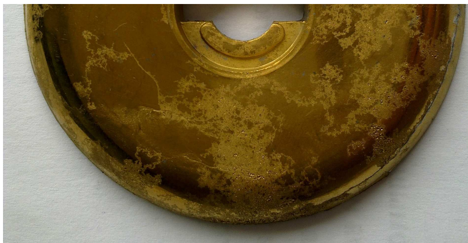
Рис. 1. Заготовка с покрытием TiN: сплав АК5М2.
