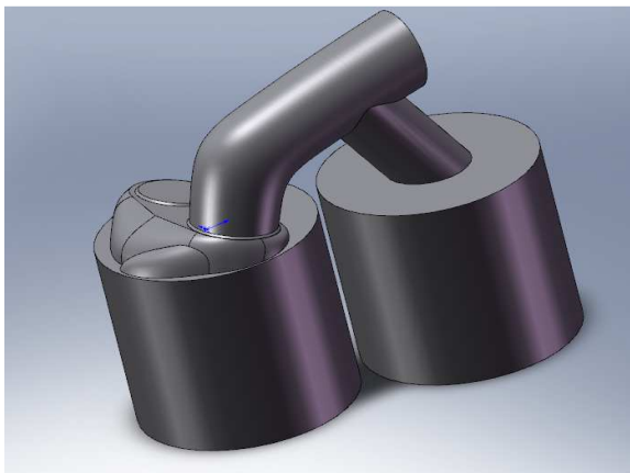
Рис. 1. Модернизированная с ресивером расчетная область в CADSolidWorks
