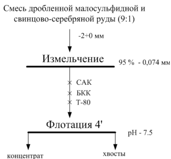
Рисунок 2. а) Схема флотационного обогащения, б) кинетика измельчения смеси
