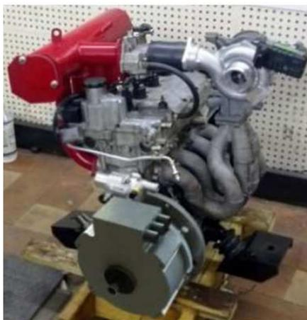
Рисунок 2 – Полномасштабный макет генераторной установки МЗУ
