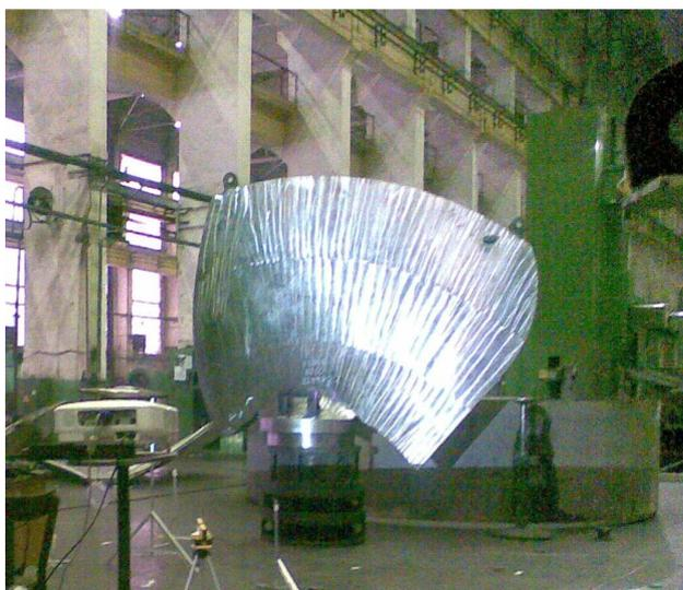
Рисунок 2 - Лопасть рабочего колеса лопастно-поворотной турбины Святогорской ГЭС (проба № 33781)
