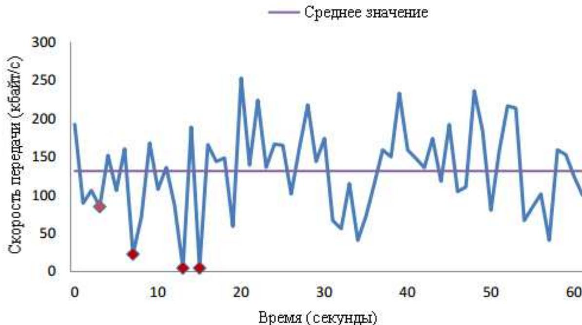
Рис. 1. Красные маркеры сигнализируют о прерывании в воспроизведении видеопотока при изменении ширины пропускной способности канала передачи данных
