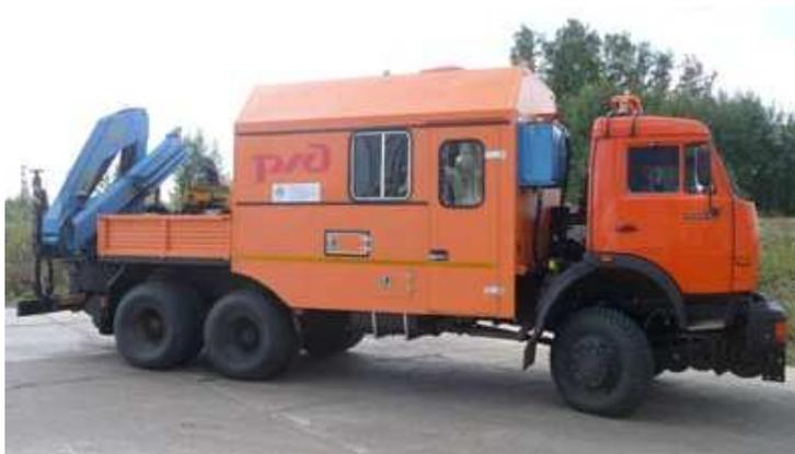
Рисунок 3 – Универсальная машина на комбинированном ходу УМК-6Е
