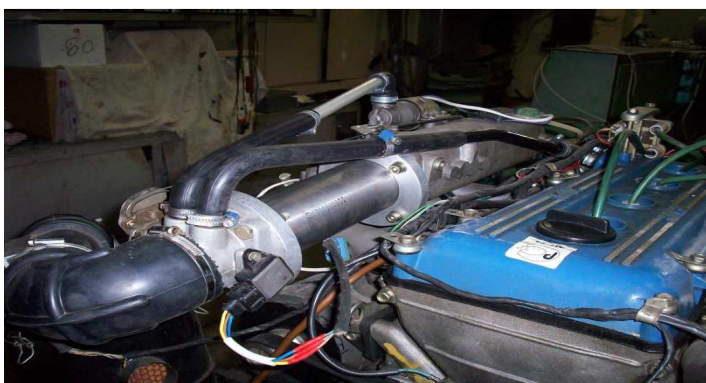
Рис. 3. Общий вид двигателя с установленной модернизированной впускной системой.
