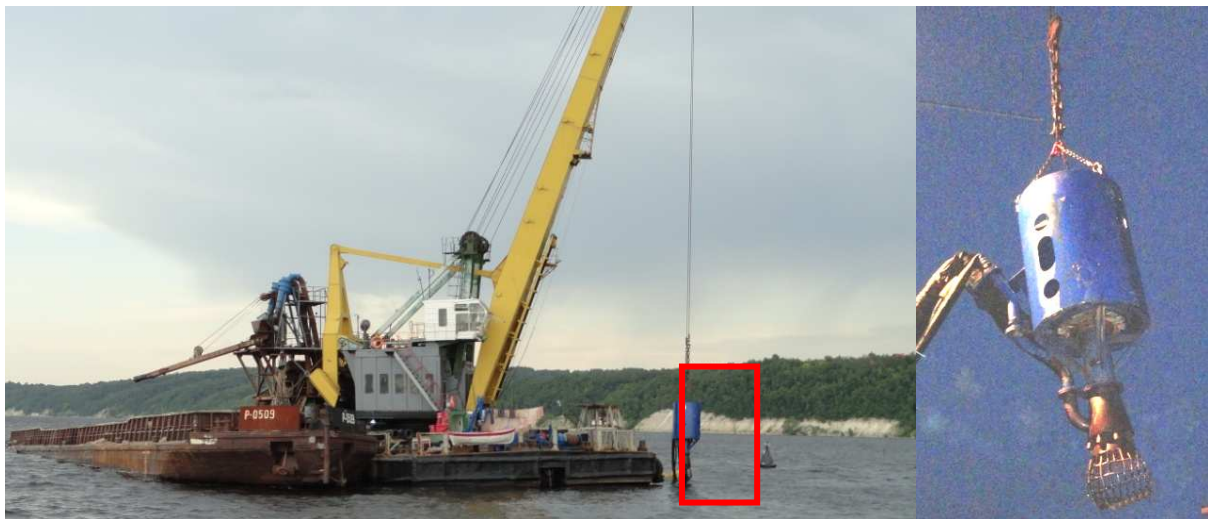
Рис. 3. КПЛ 16-30 с погружным насосом типа DOP без рыхлителей
