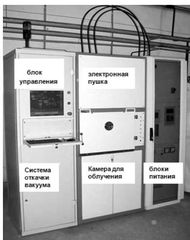
Рисунок 4. Общий вид установки для импульсного электронно-пучкового облучения металлокерамических сплавов
