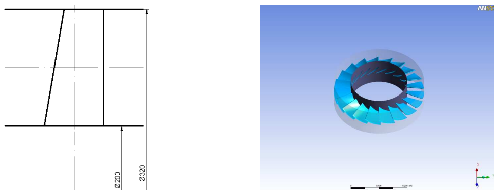
Рис. 2. Меридиональное сечение ТК (слева) и трехмерная модель решетки ТК (справа).
