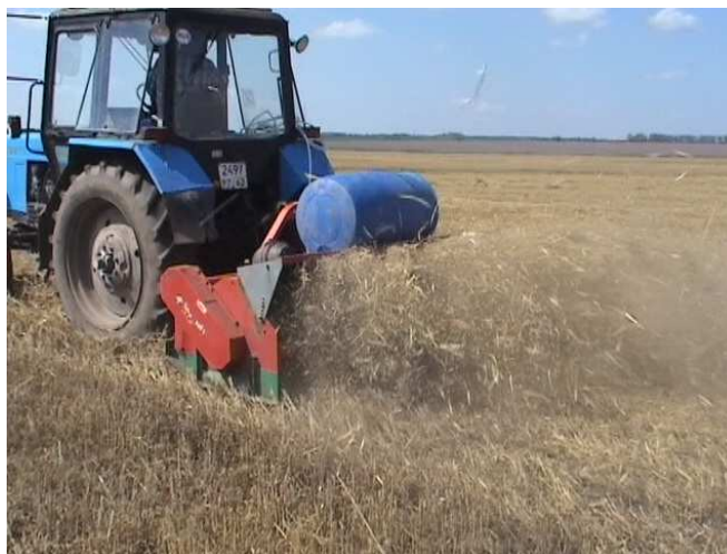
Рисунок 2. – Эксплуатационные испытания устройства для утилизации НЧУ
