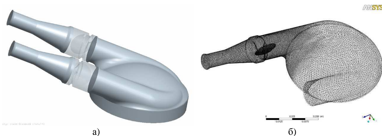
Рис. 1. Модели: а) 3D-модель ИЖС; б) КЭ модель внутреннего объема ИЖС
