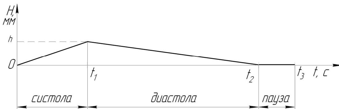
Рис. 1. Закон движения толкателя в зависимости от времени  $H = f(t)$
