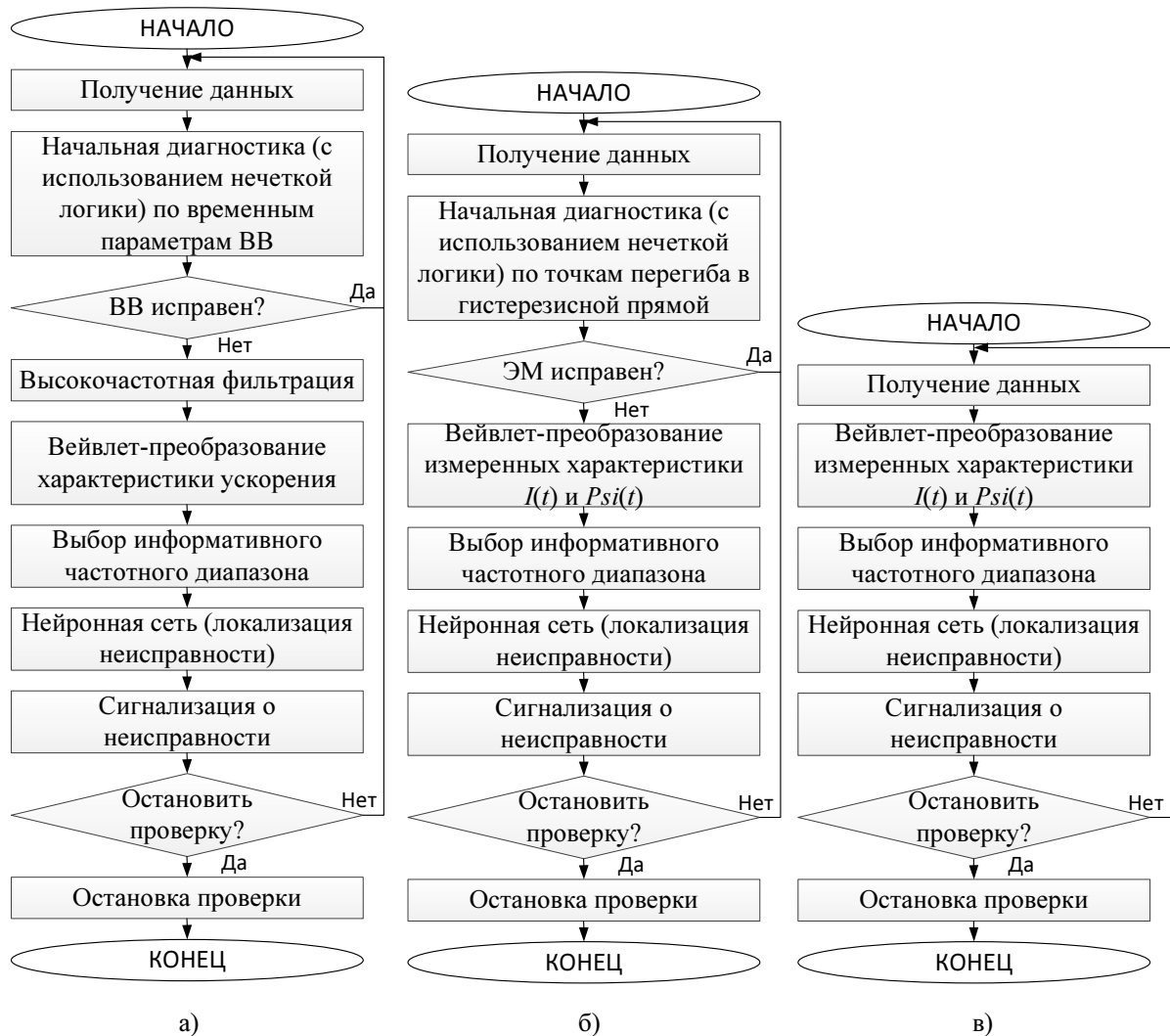
Рис. 1. Алгоритмы диагностики ЭМ и ВВ: а – двухэтапный алгоритм для диагностики ВВ; б – двухэтапный алгоритм для диагностики ЭМ; в – одноэтапный алгоритм для диагностики ЭМ
