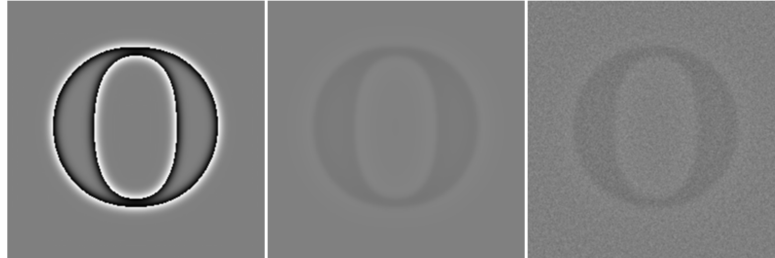
Рисунок 2 - Модельный пример. Слева направо показаны лапласианы для: исходного изображения, расфокусированного, расфокусированного с добавлением шума. Динамический диапазон лапласианов был нормирован.
