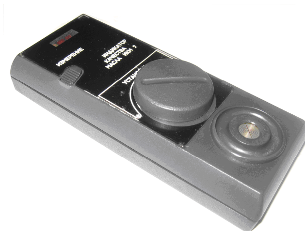
Рис. 2. Экспресс-анализатор качества работающих масел ИКМ-2
