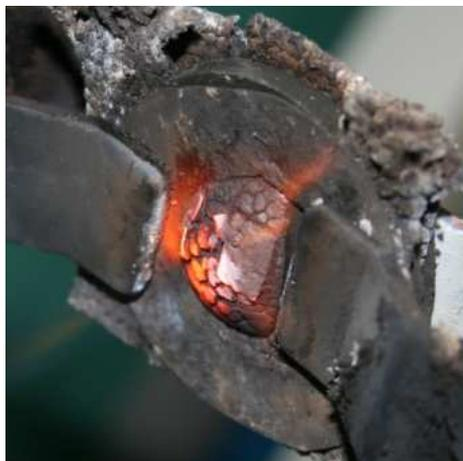
Рисунок 1. Вид поверхности кокса при воздействии на образец пламени горелки
