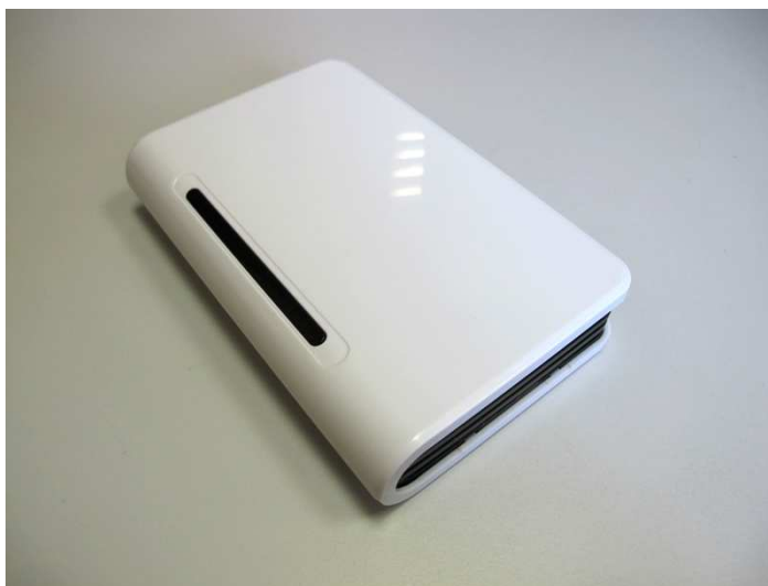
Рис. 1. Стационарное устройство Access Point, используемое в качестве опорного датчика
